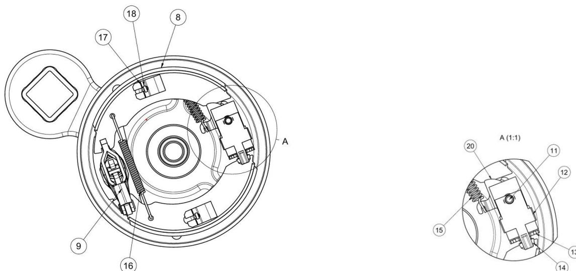
Neue Bremsbacken mit Federn in die Nachstellschraube (13) stecken und mit Zug die Backen so spreizen, daß das Spreizschloß eingehangen werden kann. Danach die Niederhaltefedern (18) befestigen.
