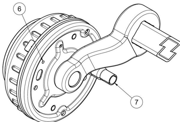
Etwa noch vorhandenes Spiel in der Bremsanlage durch nachstellen der Bremsseile am Seilausgleich bzw. an der Nachstellvorrichtung der Bremsbetätigungsorgane (Auflaufeinrichtung) ausgleichen (siehe Betriebsanleitung der jeweiligen Hersteller bei Fremdprodukten).
